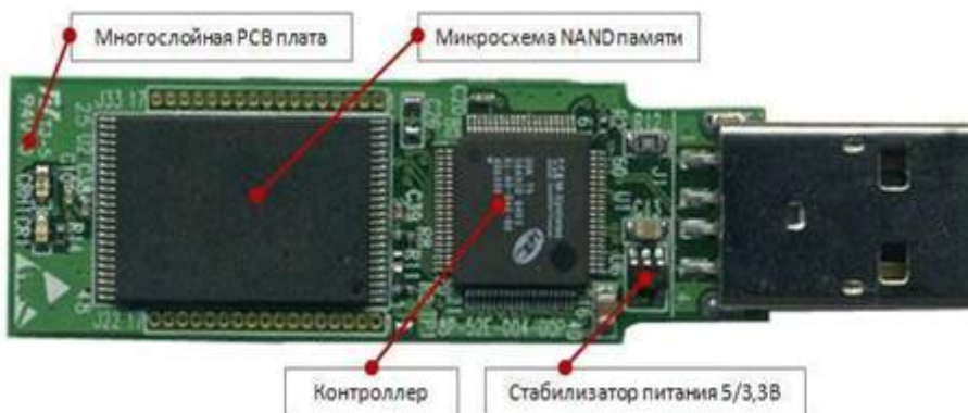
Рисунок 5 - Расположение основных элементов флеш-накопителя
