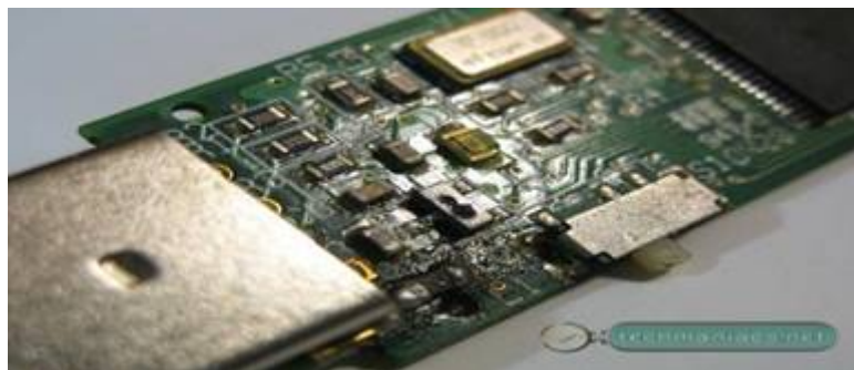
Рисунок 8 - Внешний вид флэш-накопителя со сгоревшим стабилизатором
