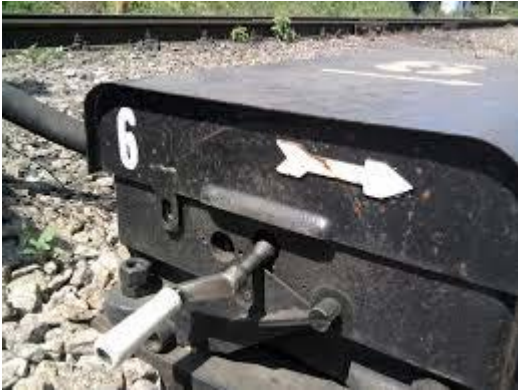
Рисунок 10. Курбель для перевода централизованной стрелки вручную
