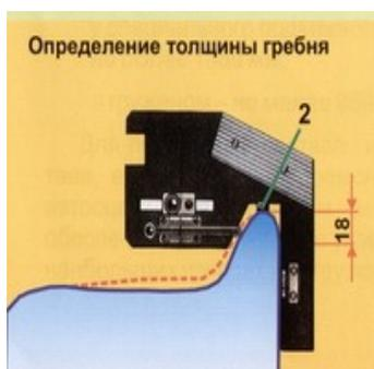
При этом используется горизонтальная измерительная ножка на оборотной стороне шаблона. Толщина гребня измеряется на высоте 18 мм от его вершины благодаря определенному положению ножки на корпусе шаблона.
