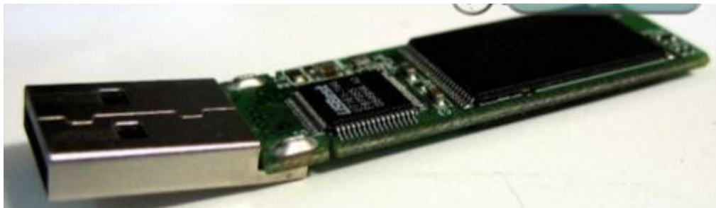
Рисунок 7 - Внешний вид флеш-накопителя со сломанным разъемом
