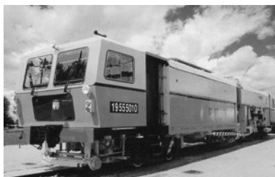
Рисунок 44. Выправочно-подбивочно-рихтовочная машина для стрелочных переводов UNIMAT 08-275 3S
